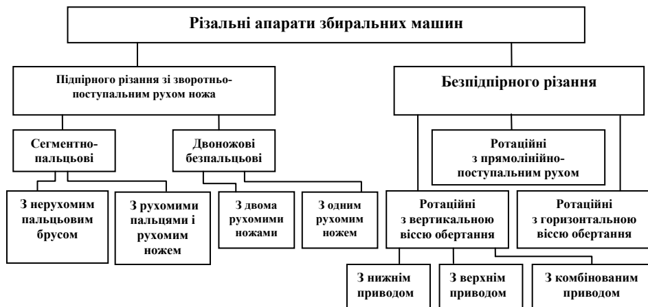
Рис. 6.3. Класифікація різальних апаратів збиральних машин
