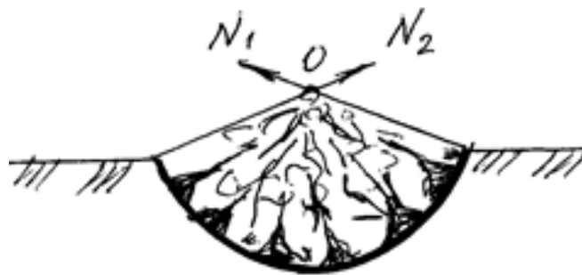
Рис. 4.3. Схема руйнування ґрунту стисканням увігнутою поверхнею робочого органа
