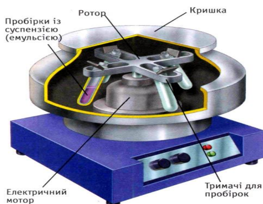
Рис. 37. Внутрішня будова центрифуги
