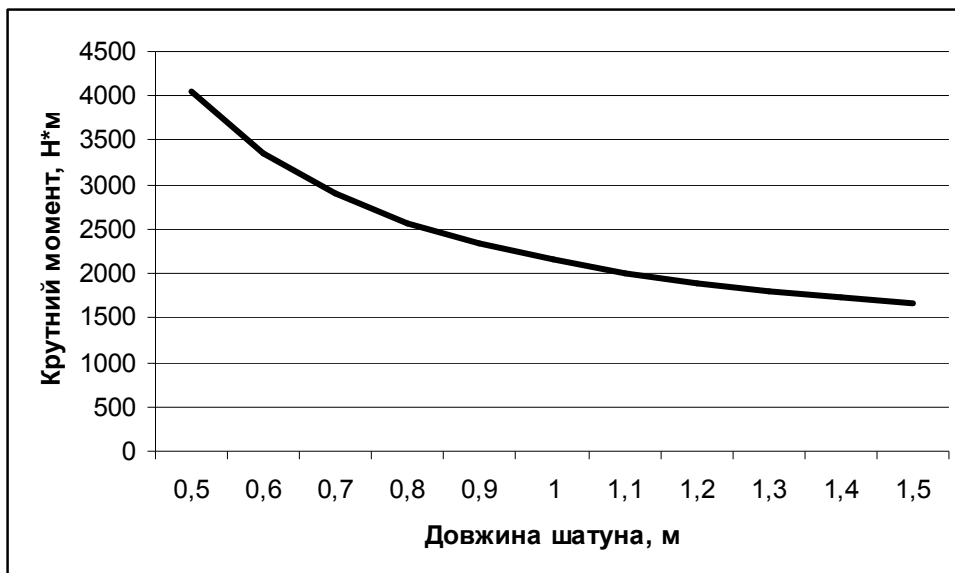
Рис. 4.6. Графік зміни максимального значення загального моменту сил опору M_{заг.маx} в залежності від довжини шатуна
