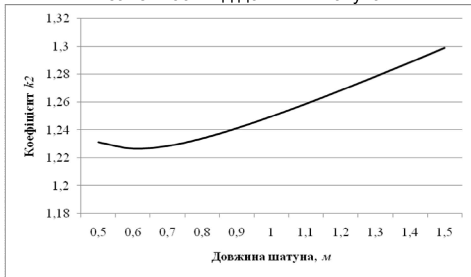
Рис. 4.16. Графік зміни відносного показника k_2 в залежності від довжини шатуна
