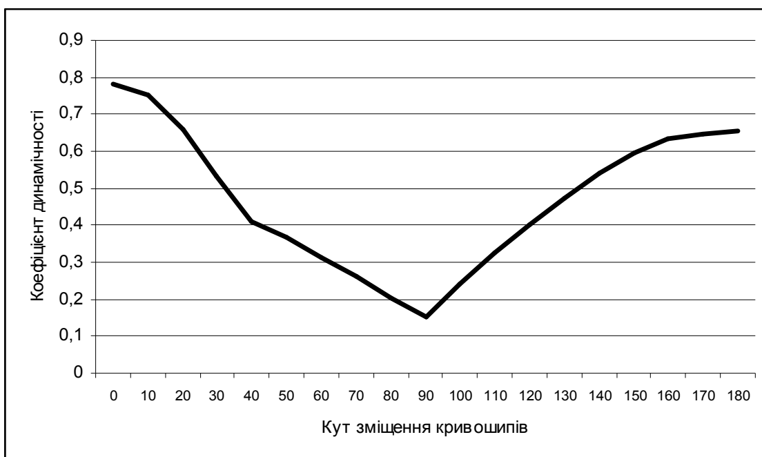
Рис. 6.21. Графік зміни коефіцієнта динамічності руху в залежності від кута зміщення кривошипів
