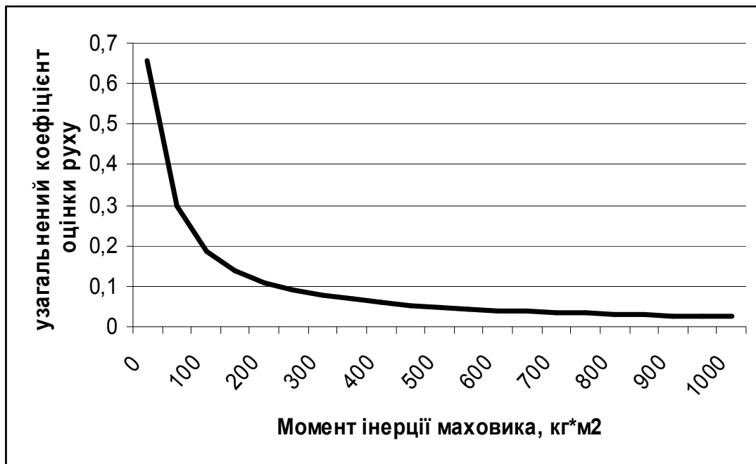
Рис. 6.10. Графік зміни узагальненого коефіцієнта оцінки руху в залежності від зміни моменту інерції маховика
