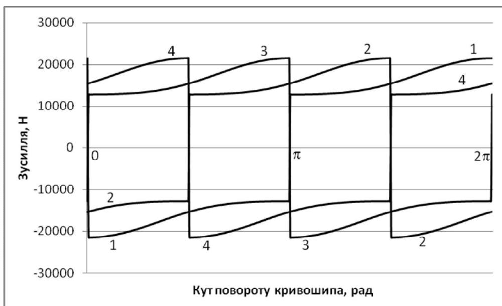
Рис. 5.10. Графіки зміни зусиль в шатунах F_1 – 1, F_2 – 2, F_3 – 3 та F_4 – 4 в залежності від кута повороту кривошипа
