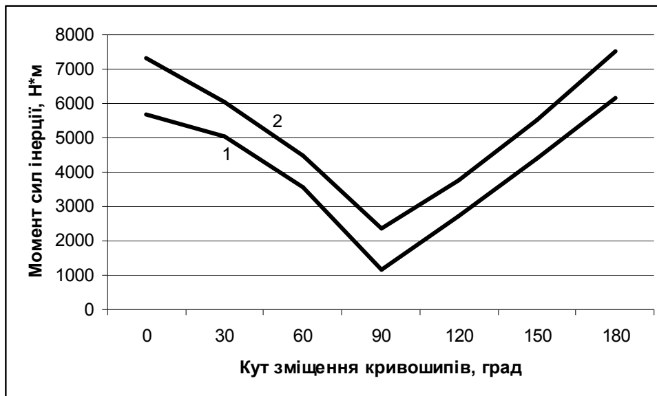
Рис. 3.9. Графіки зміни відхилень зведеного моменту від сил інерції \Delta M_{imax} – 1 та \Delta M_i – 2 в залежності від кута зміщення кривошипів
