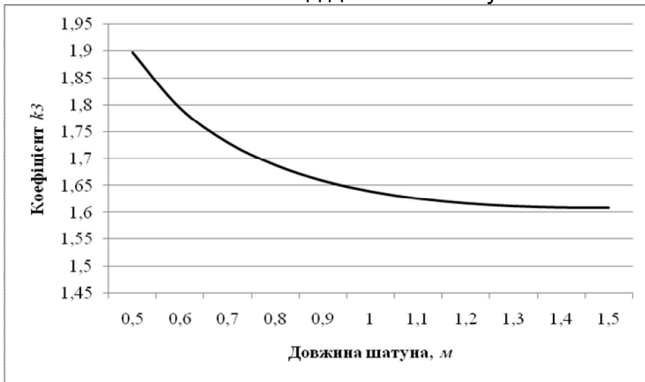
Рис. 4.11. Графік зміни відносного показника k_3 в залежності від довжини шатуна
