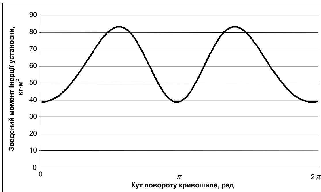
Рис. 6.3. Графік зміни зведеного моменту інерції установки від кута повороту кривошипа
