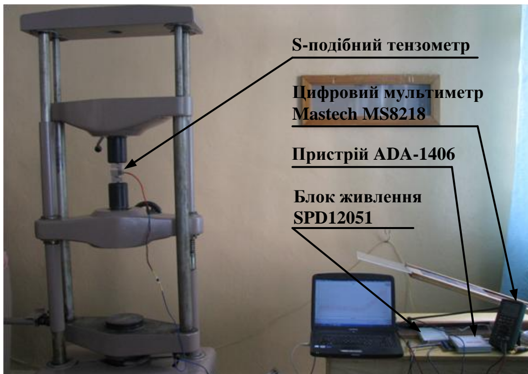
Рис. 4.9. Тарування датчика зусилля
