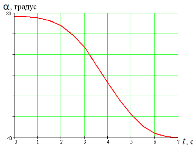
Рис. 4.8. Графік зміни куткової координати стріли в часі:
