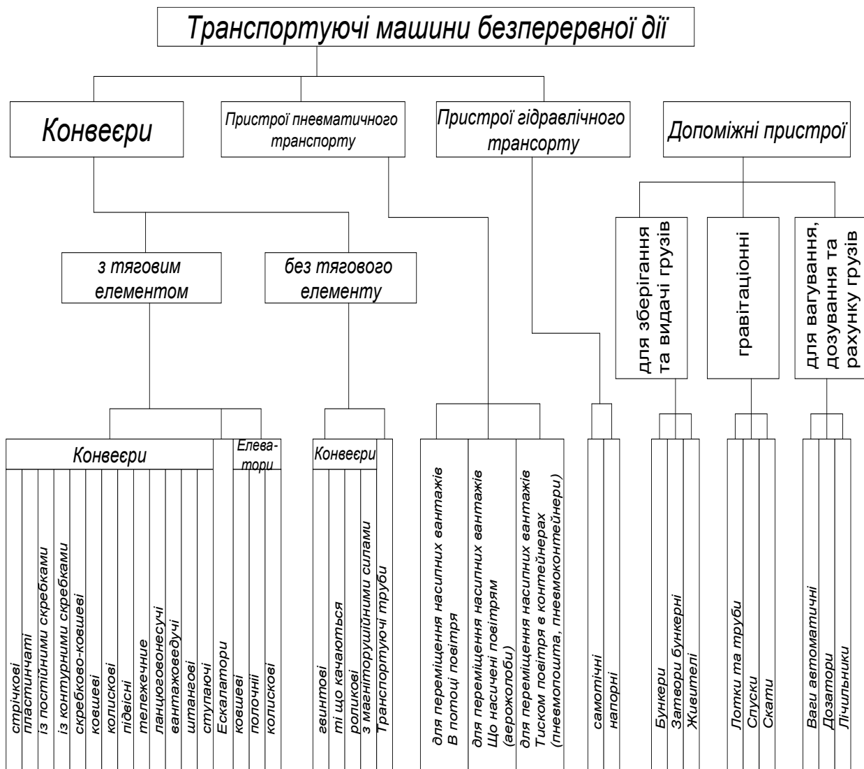
Рис. 1.1. Класифікація транспортуючих машин безперервної дії й допоміжних пристроїв
