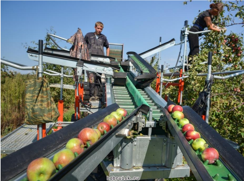
Рис. 77. Машина для механізації збирання фруктів серії ZAS
