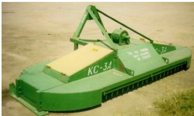
Рис. 50. Косарка КС-3А для скошування трави в міжряддях саду.
