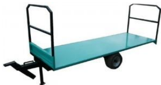
Рис. 82. Одновісний причіп для транспортування яблучних контейнерів Розмір: 3800 x 1250 x 800 Макс. навантаження – 1200 кг
