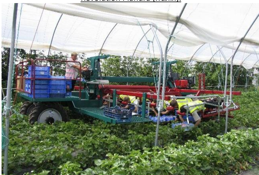
Рис. 79. Самохідний комбайн для збирання суніці.
