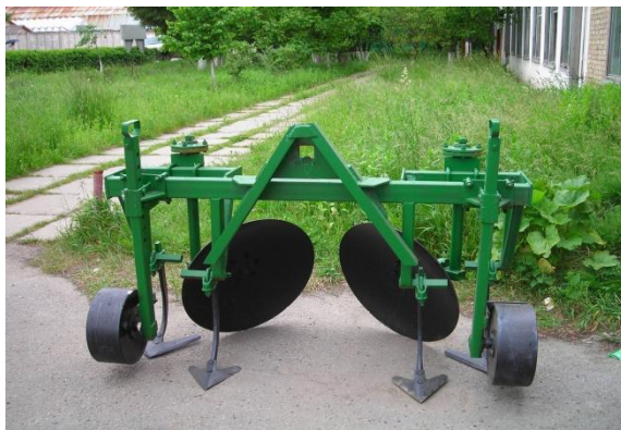
Рис. 54. Підгортач ПВМ-1 для підгортання вегетативних підщеп в маточнику.
