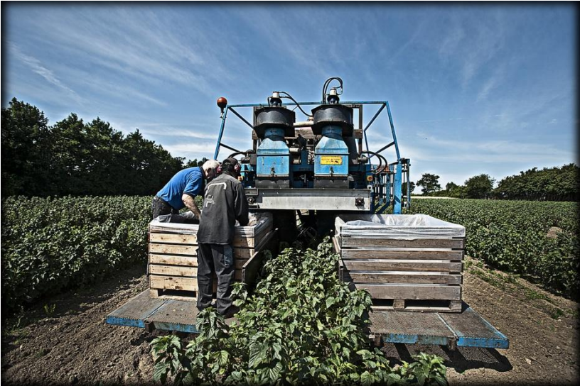
Рис. 88. Комбайнове (механізоване) збирання ягід смородини
