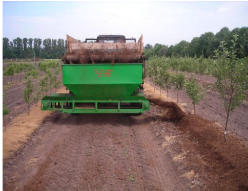
Рис. 59. Машина для внесення субстрату в на пристовбурних смугах садів з міжряддями 4-5 м, маточниках, кущових ягідниках.
