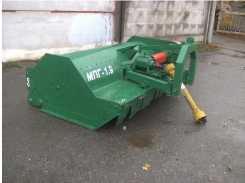
Рис. 58. Подрібнювач зрізаних гілок в інтенсивних садах (МПГ-1,9)
