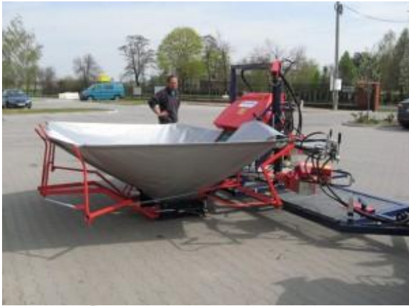
Рис. 80. Машина для збору плодів вишні.
