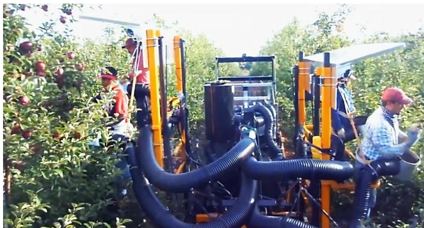
Рис. 81. Напівавтоматичний метод збору яблук.
