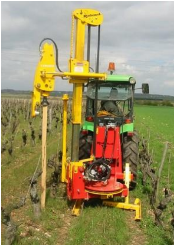
Рис. 61. Стівпостав Rabaud VIBRESCOPIIC II
