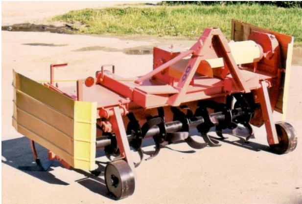
Рис. 57. Фреза ФЯ-2 для суцільного обробітку ґрунту і знищення бур'янів в міжряддях кущових ягідників.
