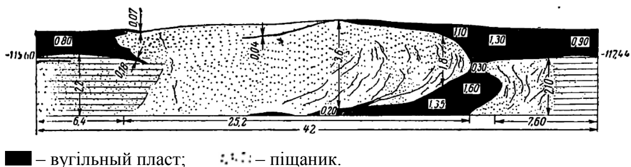
Рис. 3.7. Геологічна документація гірничої виробки (розріз по штреку пласта k_2 , шахта «Червона зірка», Торезантрацит)
