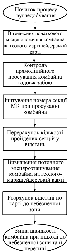
Рис. 3.10. Алгоритм визначення точного місця розташування
