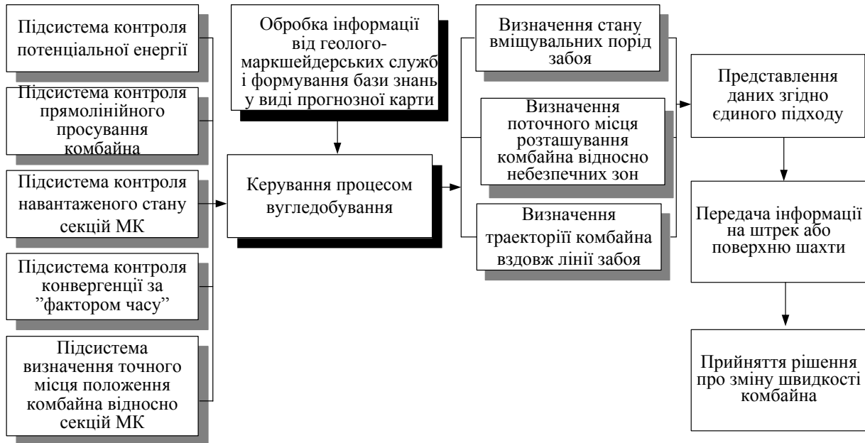
Рис. 2.10. Функціональна архітектура комплексної системи стану ВЗ
