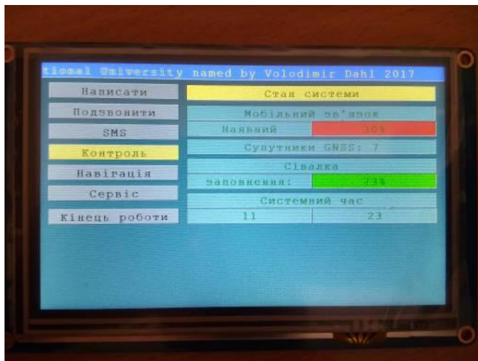
Рисунок 3.12 - Інтерфейс для контролю стану системи та обладнання.
