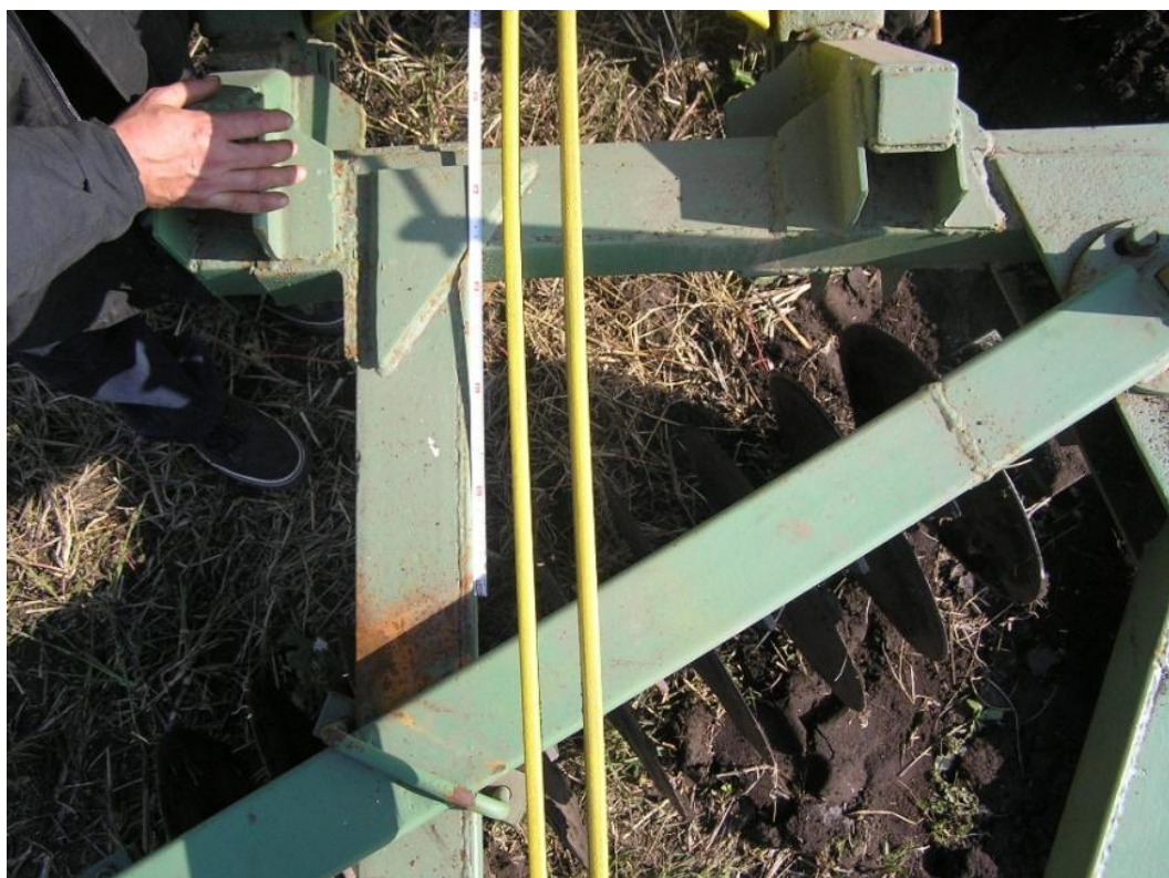
Рис. 2.34 – Установка кута атаки дискової батареї плуга з дисковим подрібнювачем
