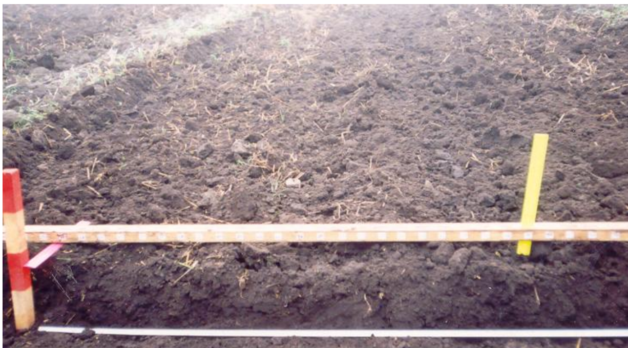
Рис. 2.15 – Вимірювання вирівняності поверхні поля на одному з варіантів дослідження якості роботи комбінованого плуга
