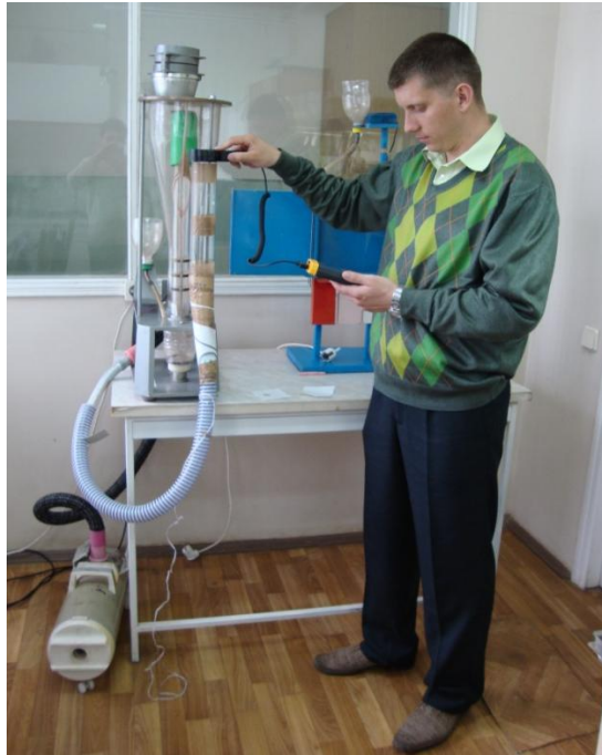
Рис. 3.20 – Вимірювання швидкості зависання фракцій яєць
