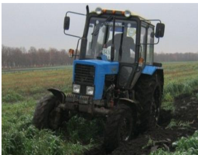
Рис. 3.13. Трактор Кий-14102 обладнаний системою двоступеневого підігріву дизельного біопалива при виконанні польових випробувань
