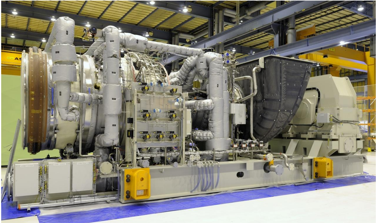
Рис. 8.6. Газова турбіна SGT-800 виробництва Siemens потужністю 47 МВт
