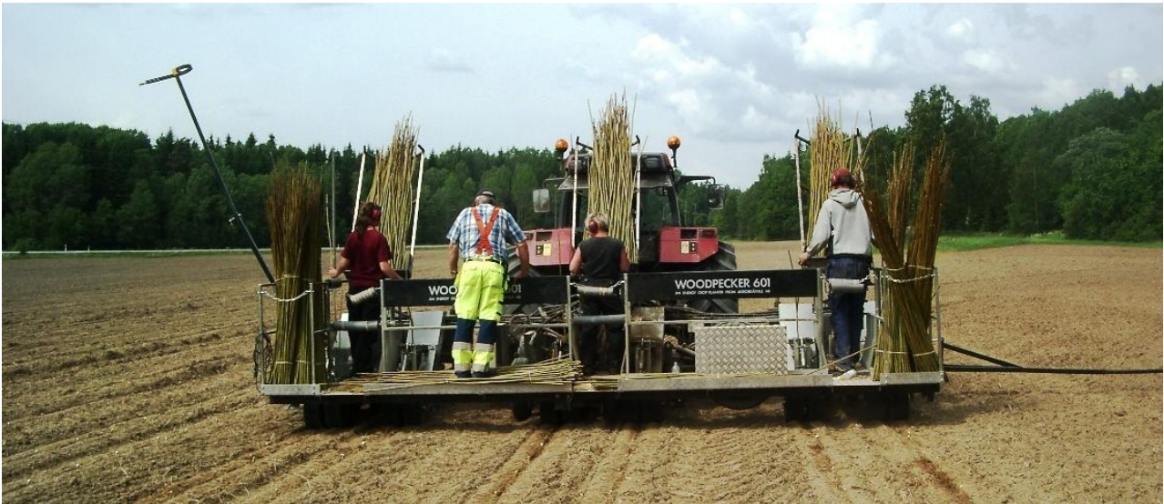
Рис. 10.6. Висаджування саджанців енергетичної верби за допомогою спеціальної саджалки
