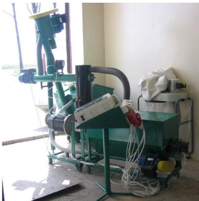
Рис. 9.8. Лінія гранулювання біомаси ЕСО-ВІО-100 виробництва НУБіП України (Чехія-Україна)
