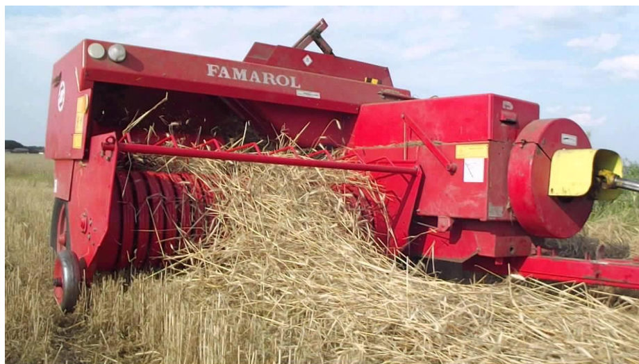
Рис. 9.3. Прес-підбирач поршневого типу для формування малогабаритних тюків, марки FАMAROL Z-511 (Unia Group)
