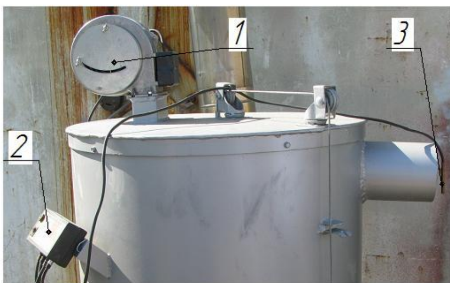
Рис. 9.19. Котел для спалювання соломи із верхнім горінням
