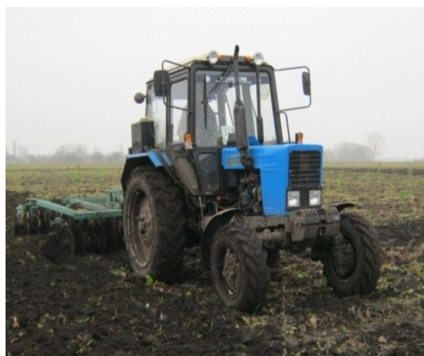
Рис. 3.13. Трактор Кий-14102 обладнаний системою двоступеневого підігріву дизельного біопалива при виконанні польових випробувань
