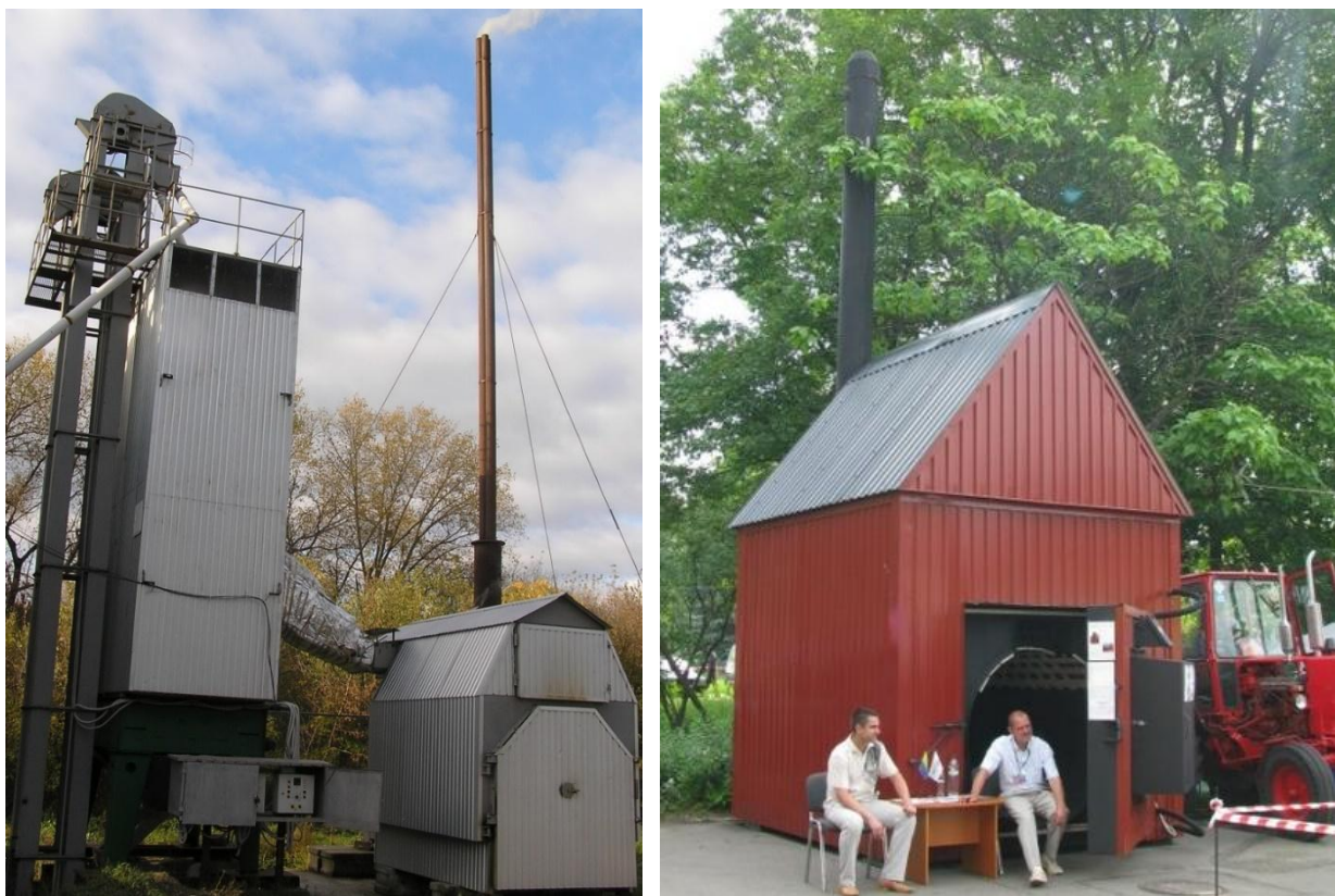
Рис. 9.14. Зерносушарка з теплогенератором ТГС-500 у навчально-дослідному господарстві НУБіП України «Агрономічна дослідна станція» та опалювальний котел на соломі виробництва ЮТЕМ
