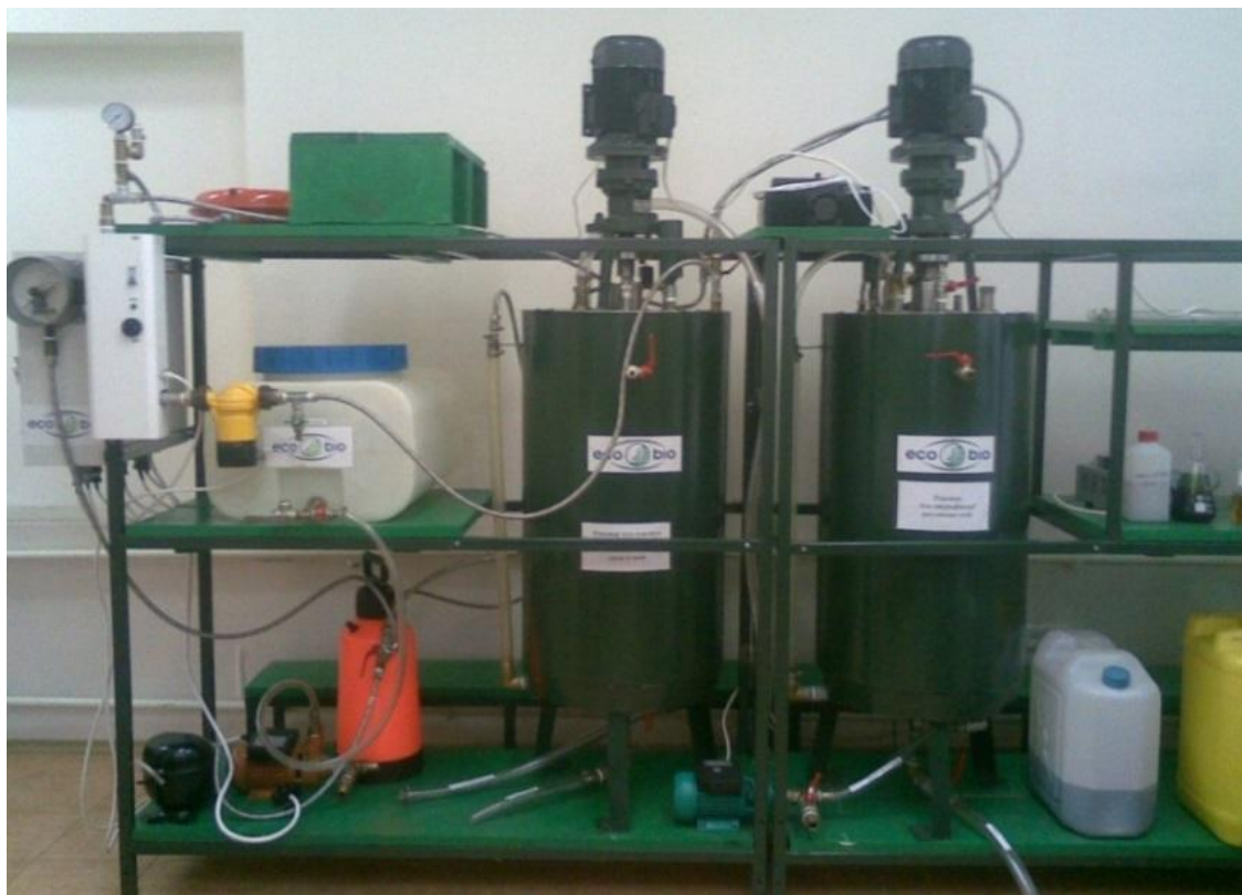
Рис. 2.7. Обладнання для виробництва дизельного біопалива продуктивністю 100 л/год.
