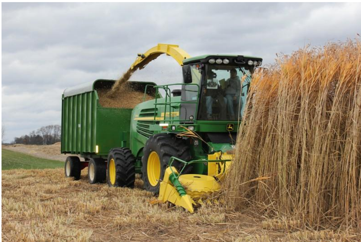
Рис. 10.9. Збирання трав'янистих енергетичних культур кормозбиральним комбайном
