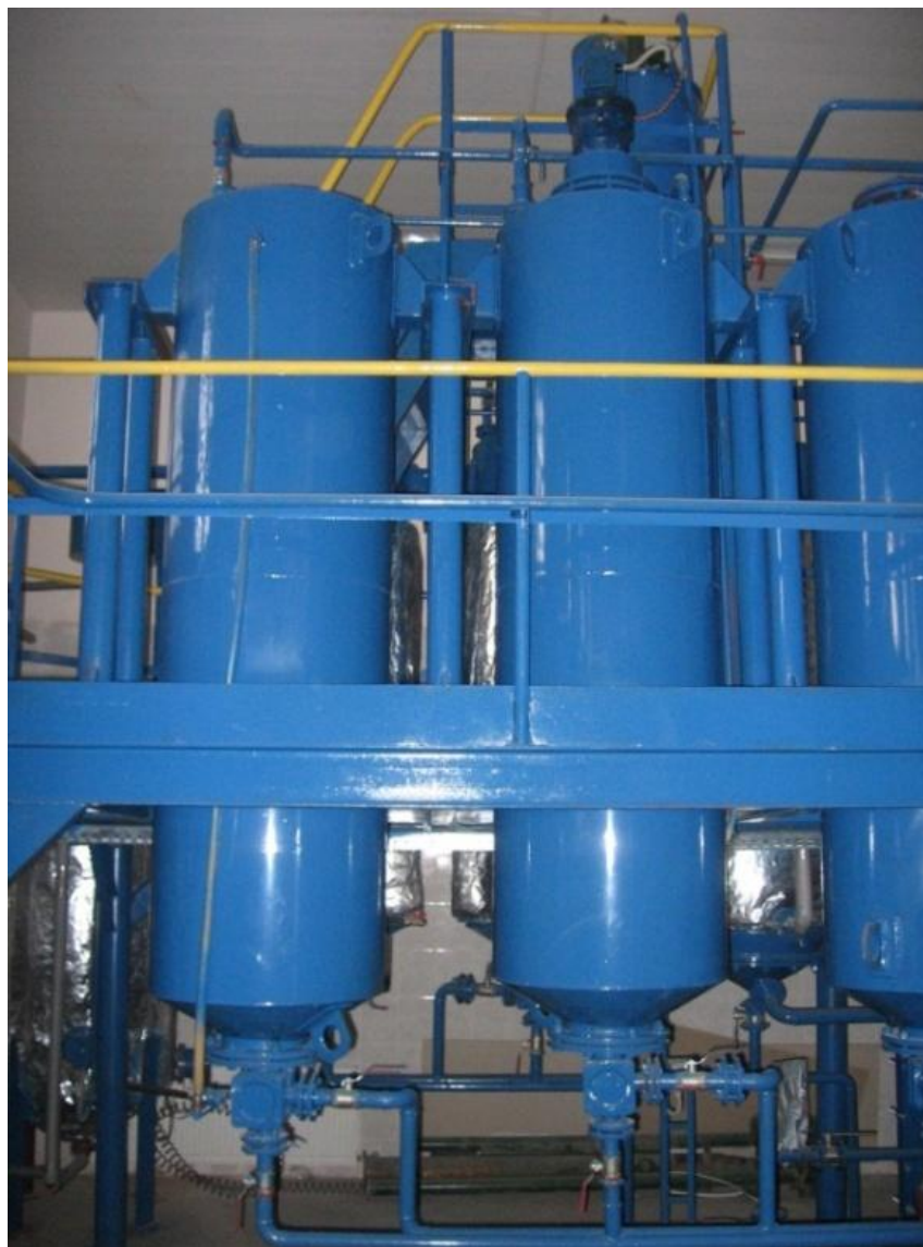
Рис 2.8. Обладнання для виробництва дизельного біопалива продуктивністю 300 т/рік
