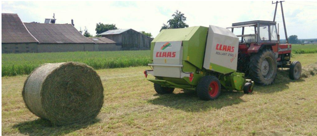
Рис. 9.4. Прес-підбирач рулонного типу для формування тюків середнього та великого типорозмірів, марки Rollant 250 (Claas)
