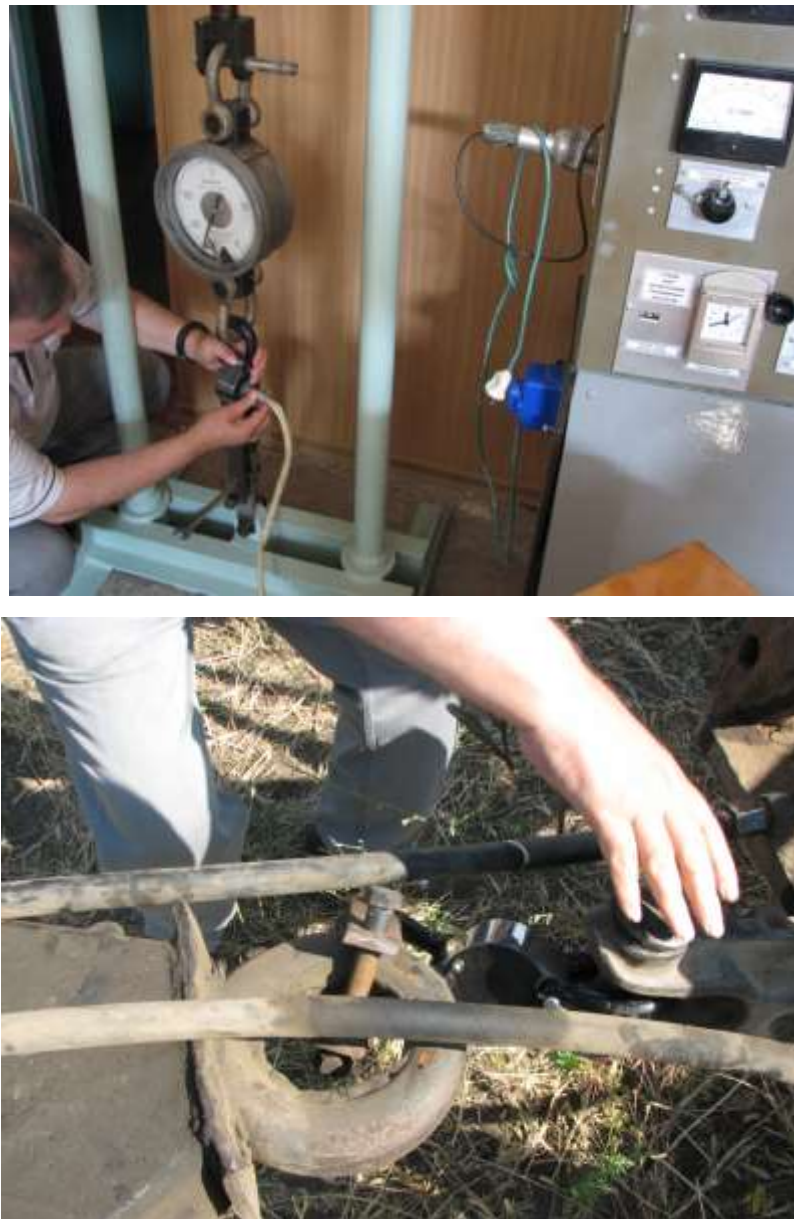
Рис. 3.6. Тензоланцюг між скобами трактора та борони
