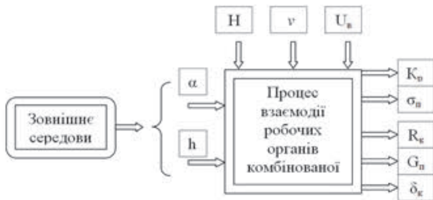
Рис. 3.2. Структурна схема процесу взаємодії робочих органів комбінованого плуга з ґрунтом
