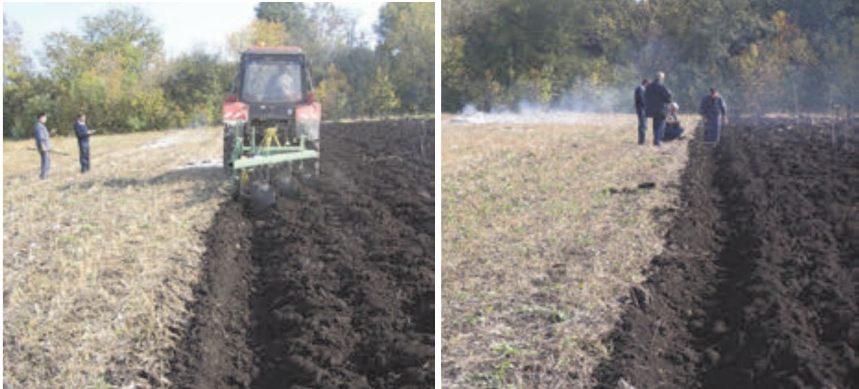
Рис. 5.3. Визначення показників якості роботи окремих груп робочих органів плуга з дисковим подрібнювачем в агрегаті з трактором МТЗ-82
