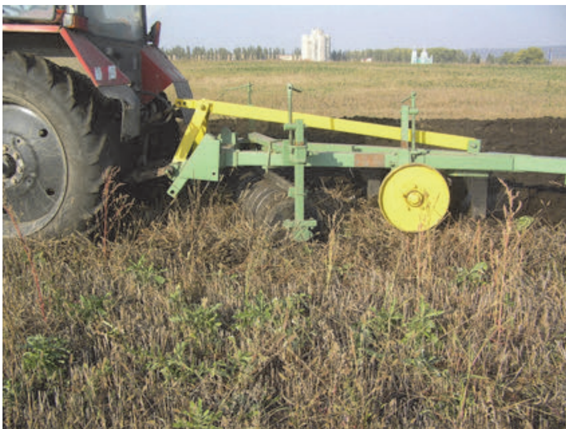
Рис. 4.1. Плуг з дисковим подрібнювачем в роботі
