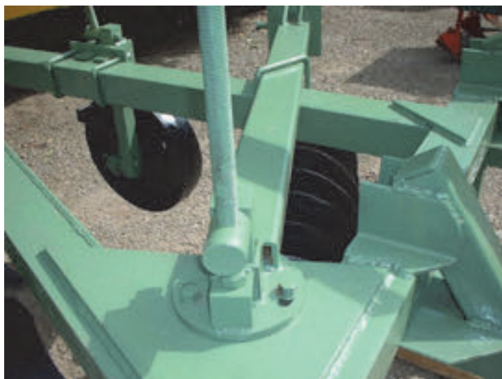
Рис. 3.4. Регулювання кута атаки ( \alpha_d ) та висоти установки ( h_d ) дискового подрібнювача
