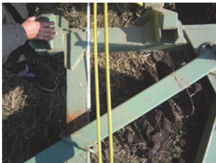
Рис. 5.4. Установка кута атаки дискової батареї плуга з дисковим подрібнювачем
