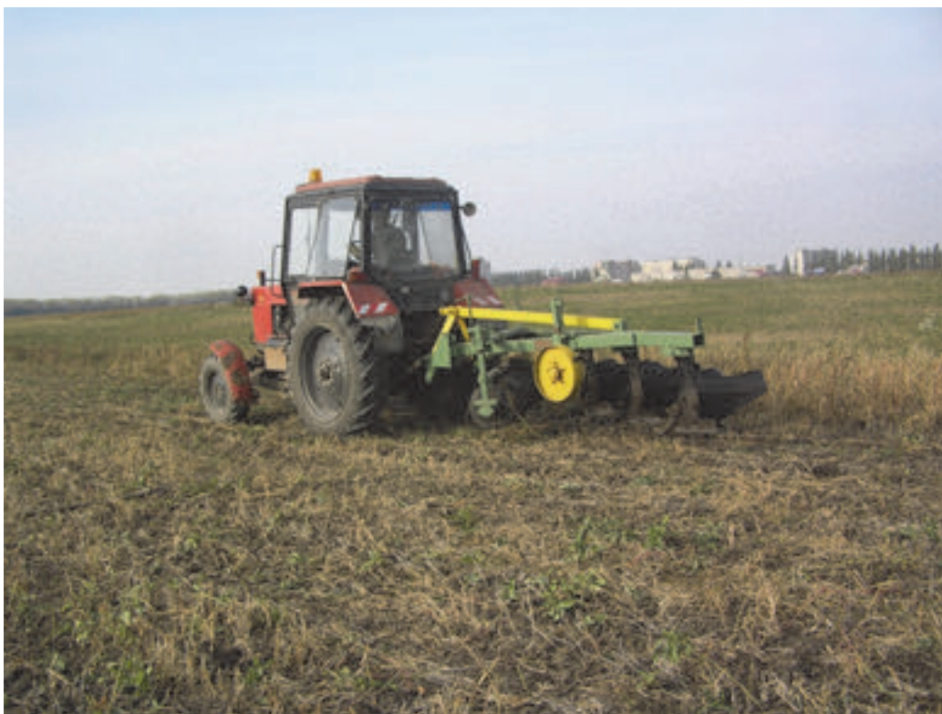
Рис. 4.11. Трактор МТЗ-82 з плугом та дисковим подрібнювачем під час проведення порівняльних випробувань
